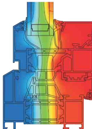
Schüco Fenster AWS 70 RL.HI Reduzierte Wärmeverluste Schüco Window AWS 70 RL.HI Reduced heat loss
